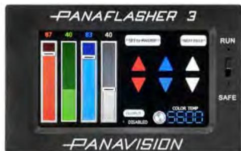
タッチパネルのフェーダーで色調整を行います。微調整を行うには、画面右の上下の矢印で、数値を1つずつ増減します。右下の数字はマスター色温度設定が5,600°Kであることを表しています。
